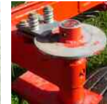
Freno de tensión regulable en las ruedas delanteras para evitar la oscilación en transporte. Adjustable tension brake on the front wheels to prevent pscilation in transport
