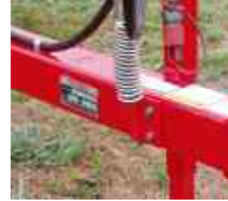
Regulación para nivelar el equipo. Regulation to level the equipment according to the height of the tractor hitch
