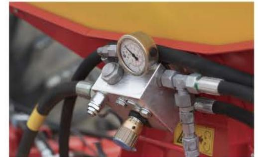
Válvula reguladora de caudal con manómetro. Regula el flujo de aire para el momento de la siembra de acuerdo al ancho de labor.
