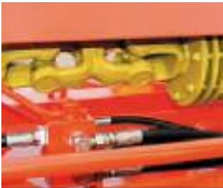
Embragues de fricción en las tres cajas de corte Friction clutches in the three cutting gearboxes
