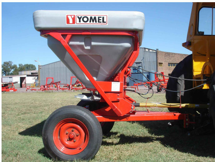
Flex 1050 de arrastre con tolva de Polietileno
