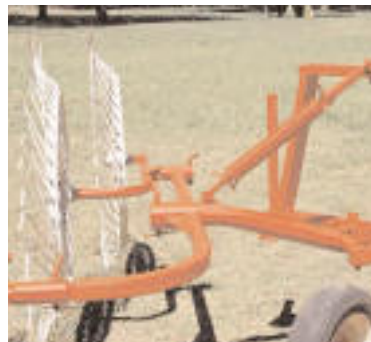
Sistema de flotación regulable, con resortes de compensación, para operar con la presión óptima sobre el terreno, sin dañar las pasturas y realizar una eficiente recolección o barrido.
