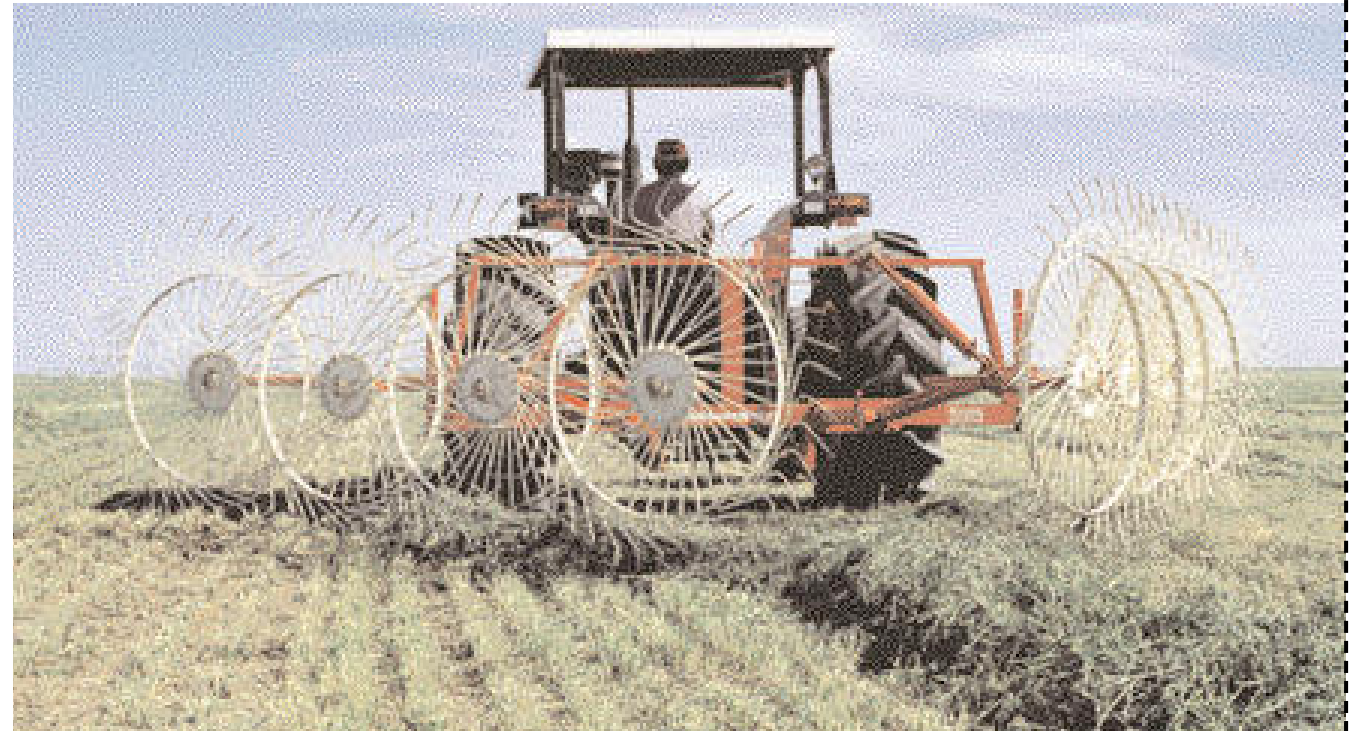
Variando la posición de los brazos, permite rastrillar, remover o airear el forraje aplastado, hacer cuatro hileras de poco volumen en una sola pasada, etc.
